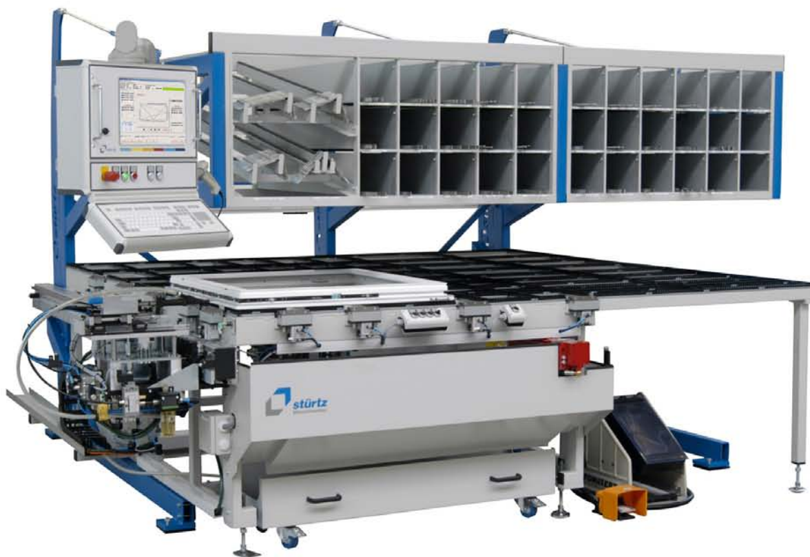
FBS-2M-H - Poloautomatický šroubovák na přišroubování dílů kování do křídla
