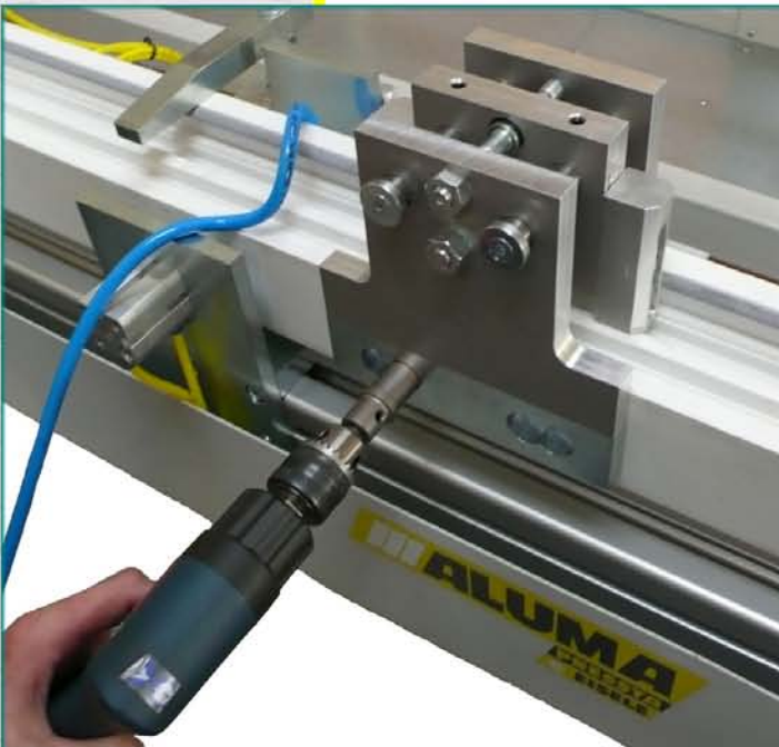
сверление отверстия для вкладки личинки замка
