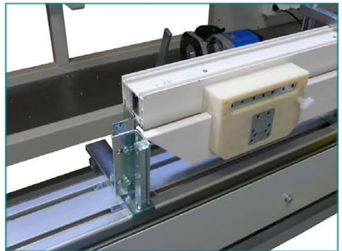
вложение рамы и створки с симметрично переставляемым упором
