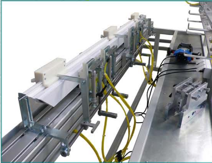
mechanisches Spannsystem für Anbringung der Türlager im Detail
