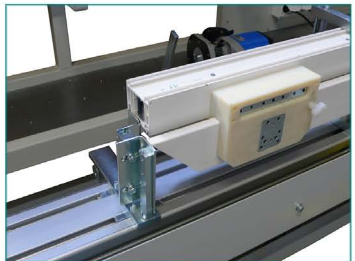
Anschlag für die Rahmen - und Flügelposition von beiden Seiten möglich
