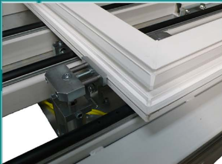
Snímacie dorazy vpravo a vľavo, pneumatically zasúvateľné pre zistenie dĺžky kovania
