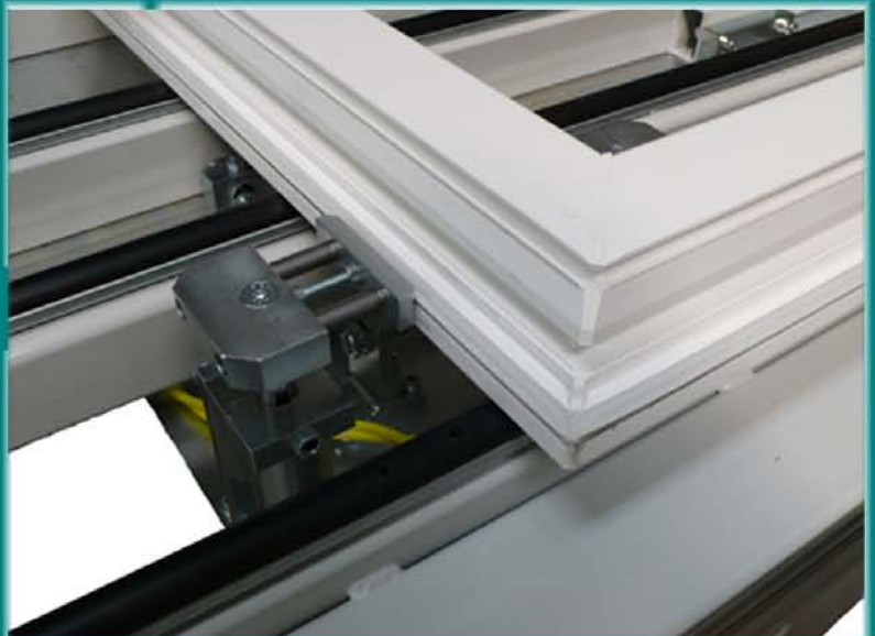
A jobb és a bal oldalon található méretfelfevő ütköztetők pneumatikusan visszahúzóhatók
