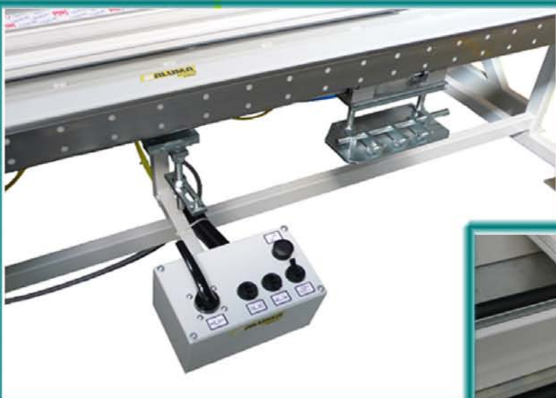
Gépkezelés a középben elhelyezkedő vezérlőpultról
