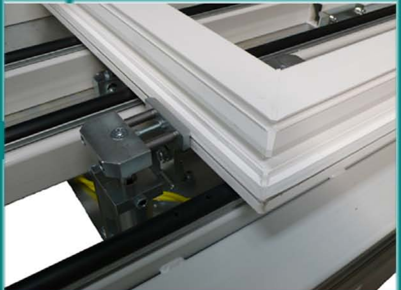
Butées amovibles à droite et à gauche placés pneumatiquement pour définir le longeur de forgeage
