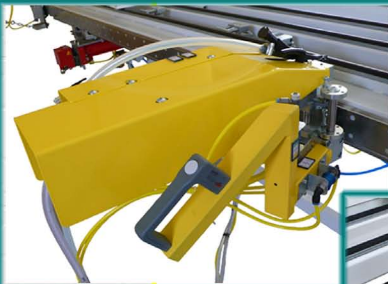
Tournevis déplaçable avec aménagement automatique des vis
